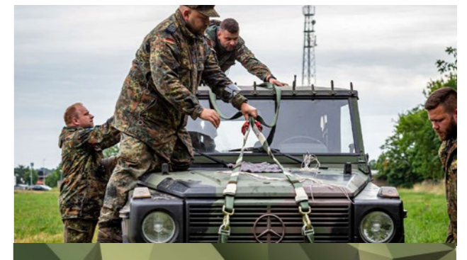
Wolf am Haken: Der Geländewagen wird für den Transport mit einem Hubschrauber CH-53 vorbereitet.
