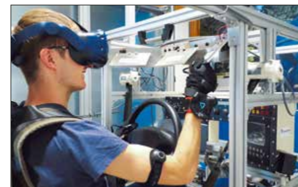
Abb. 3: Nutzer, der mit dem Hardware Mock-up interagiert, wobei der Winkelspiegel die tangible Schnittstelle darstellt
