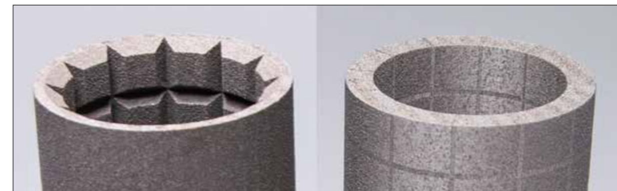
Abb. 3: Beispiele für die Integration von Bauteilfunktionalität in den strukturellen Aufbau. Links: Kerbungen sorgen für eine kontrollierte Fragmentierung beim Anliegen hoher Drücke. Rechts: Erzeugung von Sollbruchstellen durch unvollständige Aufschmelzung des Metallpulvers durch lokal verringerte Laserstrahlleistungsdichten
