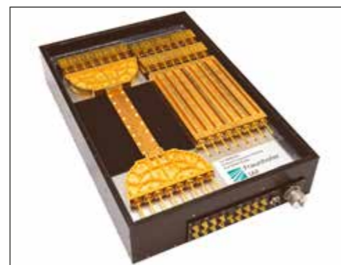
Abb. 2: Hochfrequenz-Frontend mit jeweils acht Sende- (rechter Teil) und Empfangskanälen (linker Teil)
