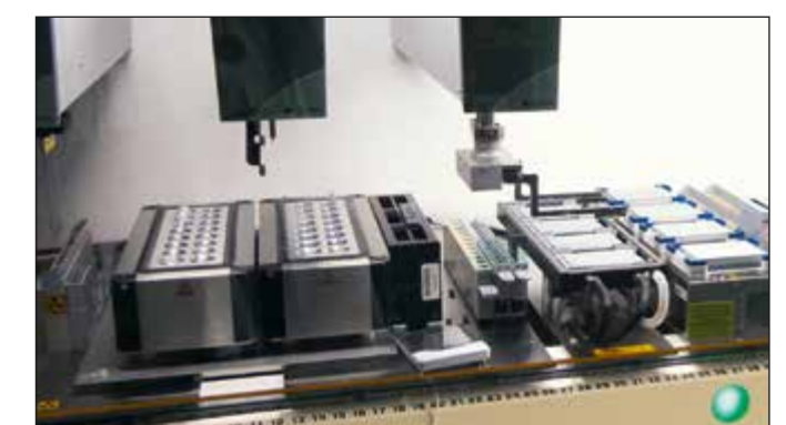
Abb. 4: Modulare Pipettier- und Inkubierplattform für die Durchführung von Radioliganden-Rezeptor-Bindungsassays. Die unterschiedliche Bestückung mit verschiedenen Liquid-Handling-Modulen erlaubt das Pipettieren von einerseits radioaktiven und andererseits von hochtoxischen Substanzen
