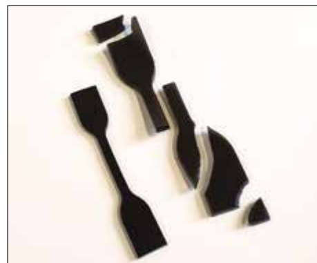
Abb. 1: Die Wahl des falschen Dichtungsmaterials führt zu übermäßiger Quellung und Bruch. Links: unquollener Zugstab; Rechts: gequollener, gebrochener Zugstab
