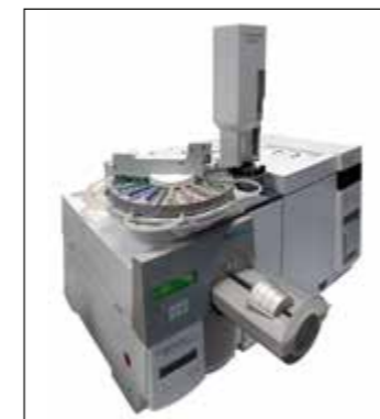
Abb. 3: Gaschromatographie/Massenspektrometrie (GC/MS) wird eingesetzt, um einzelne Kraftstoffbestandteile zu identifizieren
