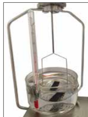
Abb. 2: Hydrostatische Waage zur Bestimmung der Volumen- und Dichteänderung gequollener Elastomerproben
