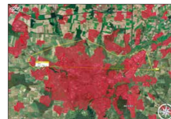
Abb. 3: MMI zur Visualisierung von Risikobereichen, in diesem Fall Gebiete mit dichter Besiedlung, und die vorgeschlagene, risikominimierte Flugroute für die UAS Mission
