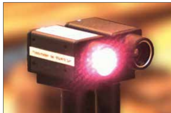
Abb. 1: Reflexion von Nahinfrarot (NIR)-Laserstrahlung an einem Bolometer-Objektiv
