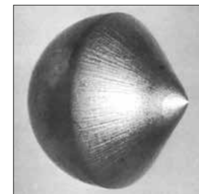
Abb. 4: Nachflugaufnahme einer ablatierten Kugel aus Aluminium bei 5000 m/s
