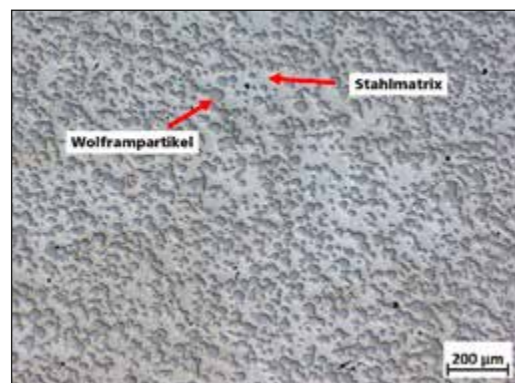
Abb. 1: Dieses Beispiel eines 3D-gedruckten Stahl-Wolfram-MMCs zeigt eine hohe erreichbare relative Dichte und eine gleichmäßige Mikrostruktur
