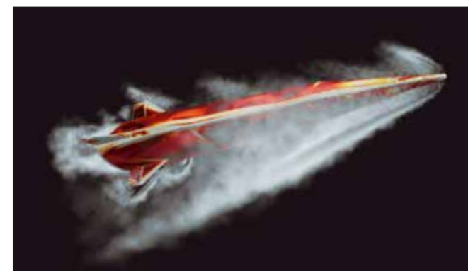
Abb. 4: Generischer Hyperschallgleitflugkörper mit Darstellung von Verdichtungsstößen (weißer Nebel) und Druck auf der Oberfläche zur Auswertung aerodynamischer Kräfte
