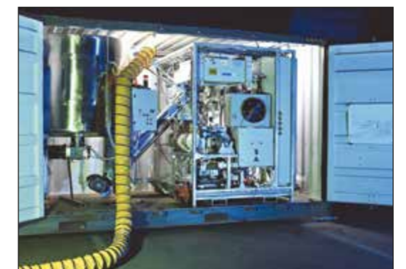
Abb. 4: Technikumspyrolyseanlage am WIWeB
