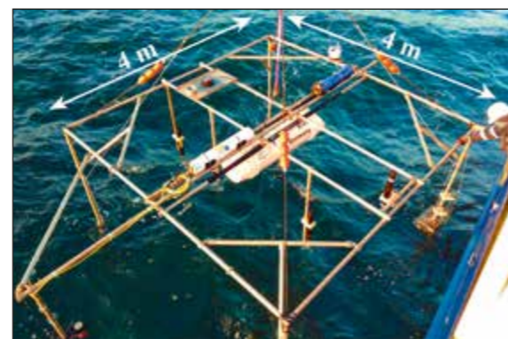
Abb. 2: Bodengestell zur Analyse der Hydro- und Morphodynamik im Einflussbereich der Messmine am Meeresboden
