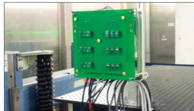
Abb. 2: Testboard mit Bauteilen im Neutronenstrahl an ChipIr
