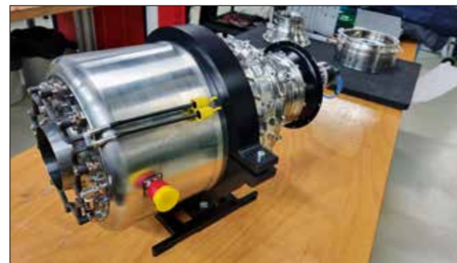
Abb. 2: Rückansicht der A800 mit additiv gefertigtem Kraftstoffverteiler
