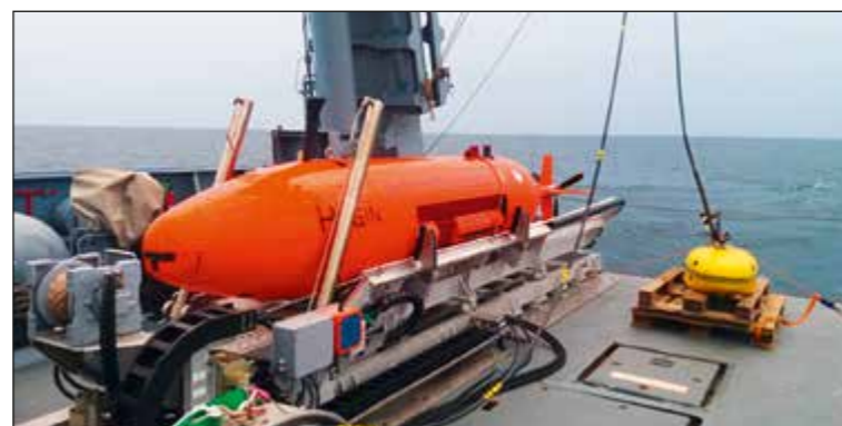
Abb. 2: Trägerfahrzeug MZB Helmsand mit Launch and Recovery System für AUV Hugin mit Akustik-Link Boje
