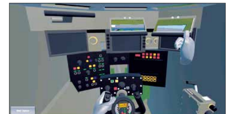
Abb. 4: Darstellung der Nutzer-Interaktion in der VR Simulation, wobei sich der Winkelspiegel aufgrund der physischen Interaktion verdreht
