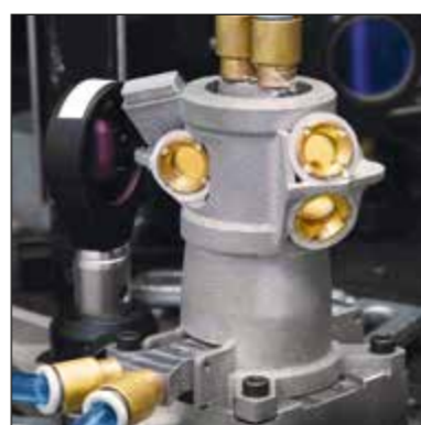
Abb. 2: Miniaturisierter OPO-Resonator vom FIRE-Typ für den Emissionswellenlängenbereich 3 – 5 \mu\text{m}
