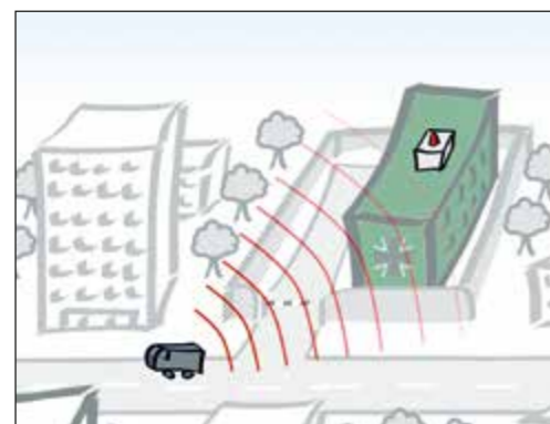
Abb. 1: Angriffsszenario elektromagnetischer Störversuche auf eine ortsfeste Einrichtung
