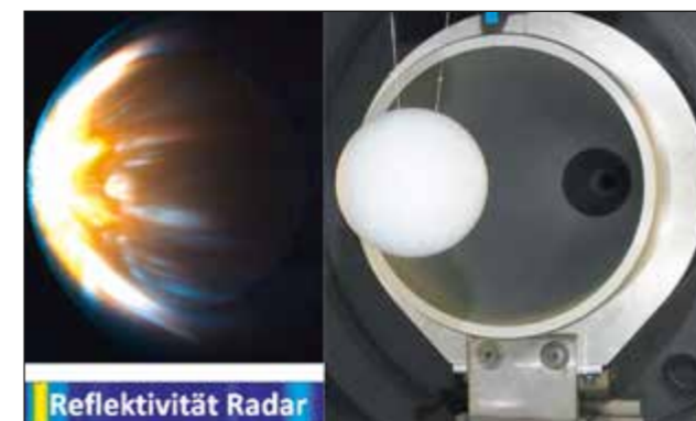
Abb. 3: Untersuchung Radarrückstreuquerschnitt bei Plasmaausbildung (Quelle: Deutsch-Französisches Forschungsinstitut ISL, Fraunhofer FHR)
