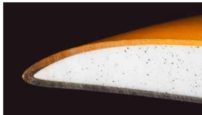
Abb. 1: Detailansicht des Sandwichaufbaus für die Composite Eintrittsschaufel
