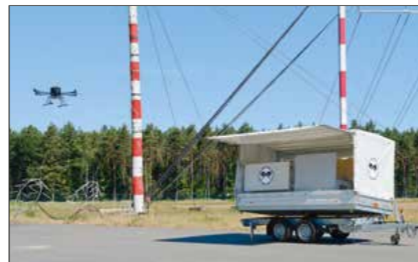
Abb. 2: Musterbeispiel einer mobilen HPEM-Quelle, dankenswerterweise zur Verfügung gestellt vom Wehrwissenschaftlichen Institut für Schutztechnologien – ABC-Schutz (Quelle: WIS, Munster)
