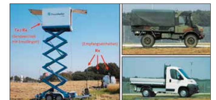
Abb. 4: Bi-Statistische Vermessung von Bodenzielen am FHR
