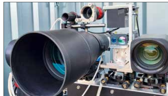
Abb. 2: Optisches Trackingsystem zur 3D Positions- und Geschwindigkeitsbestimmung von kleinen agilen UAVs im referenzierten Koordinatensystem
