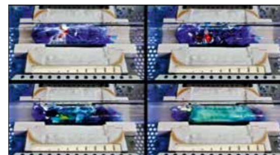
Abb. 2: Kunststoffpyrolyse im Röhrenofen. Kunststoff im Quarzglasrohr (oben links) wird geschmolzen (oben rechts). Der Crackvorgang startet (unten links) und Pyrolyseöle werden gebildet (unten rechts)
