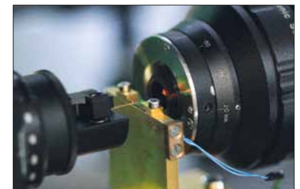
Abb. 4: Messaufbau zur Charakterisierung der AlGaAs-Wellenleiter. Pumplicht wird über eine konische Faser in einen Wellenleiter eingekoppelt
