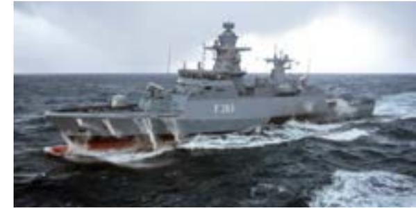
MLG 4 x schweres Maschinengewehr 12,7 mm 2 x Starter für See-/Landziel-flugkörper RBS15 Mk3, 2 x Starter für Nahbereichsflugabwehr RIM-116 RAM, 4 x Minenschiene, 2 x Täuschkörper-wurfanlage MASS
