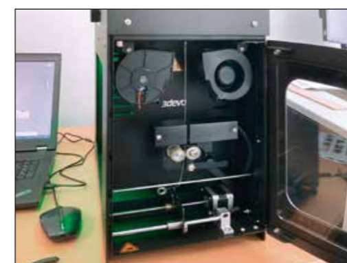
Abb. 3: Letzter Prozessschritt der Filamentherstellung Extrusion von recyceltem Material und anschließendes Aufspulen
