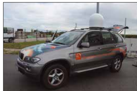
Abb. 1: SOTM Terminal mit klassischer Parabolantenne und mit Monopulse Tracking Verfahren des Herstellers EM Solutions (Quelle: ND SatCom, 2020)
