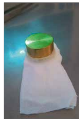
Abb. 3: Klebung des Nanofaservlieses an einen Metallzylinder als Implantat (Quelle: Fraunhofer ISC)
