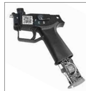
Abb. 2: Erster Funktionsillustrator einer Handgriff-Sensorik zur Erfassung der räumlichen Orientierung einer Handwaffe am Beispiel des modularen G36-Griffstücks
