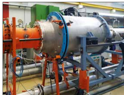
Abb. 1: Drucktonne des Mehrzweckwindkanals (MZW), montiert auf Verschiebeschleifen
