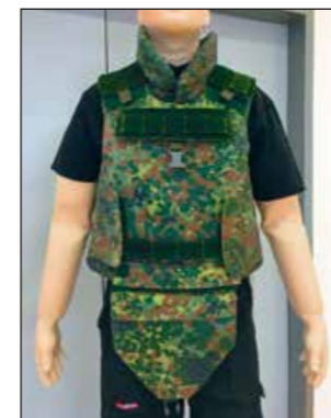
Abb. 3: Biofidel-Dummy mit angelegter Körperschutzweste inklusive Unterleib- und Halsschutz
