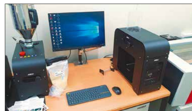
Abb. 2: Desktop-Filamentherstellungsanlage mit Trockner (links) und Extruder mit integrierter Aufpuleinrichtung (rechts)
