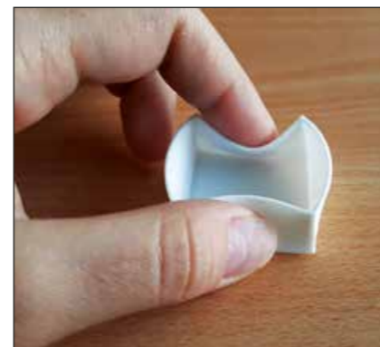
Abb. 3: Flexibilität eines Würfels, gedruckt mit Thermoplastischem Polyurethan 82A durch FFF (Quelle: Vivianne Marie Bruère de Carvalho Paiva)
