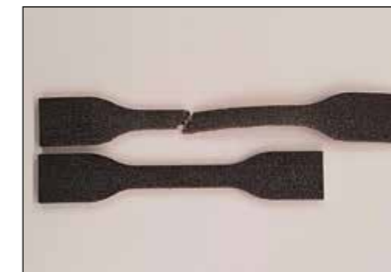
Abb. 5: Thermoplastisches Polyurethan Estane 3D TPU M95-A von Multi Jet Fusion nach dem Zugversuch (oben) und mit mittlerem Rückstellverhalten in die Ausgangsform (unten) (Quelle: Vivianne Marie Bruère de Carvalho Paiva)
