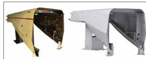
Abb. 3: Reales Hubschrauberheck (links) und mittels 3D-Scan erzeugtes CAD-Modell (rechts)
