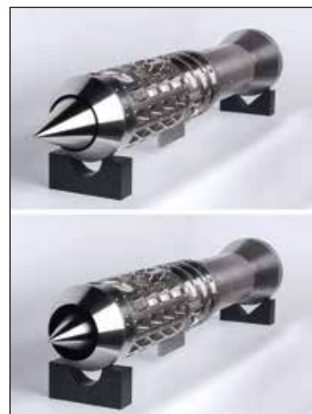
Abb. 1: Vollrotationssymmetrisches Einlaufmodell mit ausgefahrenem (oben) und eingefahrenem (unten) Zentralkörper
