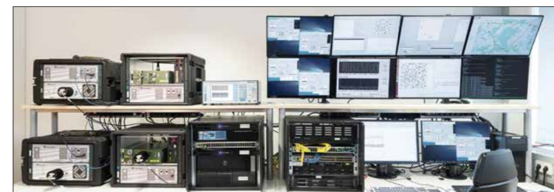
Abb. 3: Testaufbau zur Echtzeit-Evaluation von Funkgeräten mit den Prüflingen, dem Multi-Layer Simulator mit Verbindungsmatrizen und der Positionsdatenerzeugung (von links nach rechts – Quelle: Fraunhofer IIS/Paul Pulkert)
