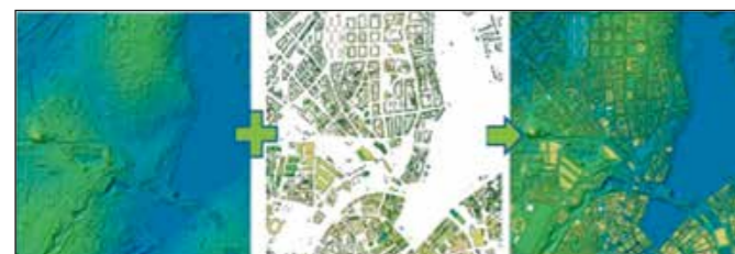
Abb. 1: Erstellung des Oberflächenmodells für einen Teil Hamburgs (c) aus Geländemodell (a), Gebäudemodellen (b) und Baumkataster (nicht dargestellt)
