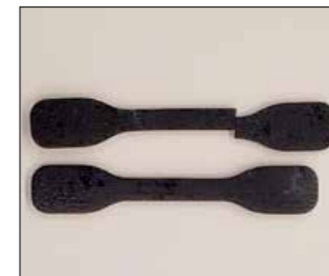
Abb. 4: Photopolymer TangoBlackPlus 70A aus dem PolyJet nach dem Zugversuch (oben) und mit hoher Rückstellung in die Ausgangsform (unten) (Quelle: Vivianne Marie Bruère de Carvalho Paiva)
