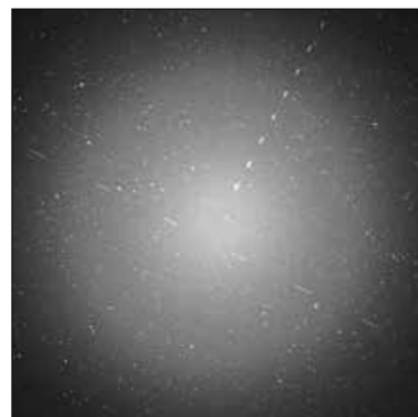
Abb. 3: Mehrfachbelichtete Aufnahme mit drei Strichspuren von überfliegenden Objekten zur astrometrischen Auswertung
