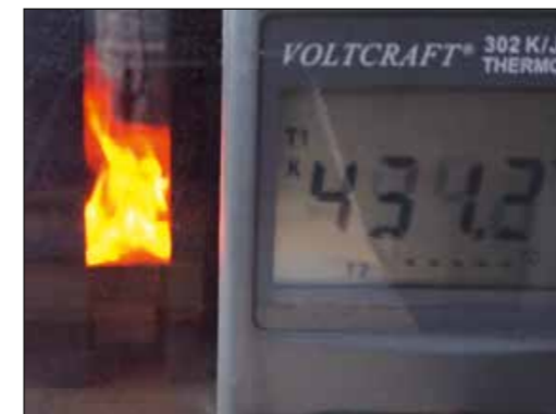
Abb. 3: Fast Cook-Off (Kraftstoffbrandtest)
