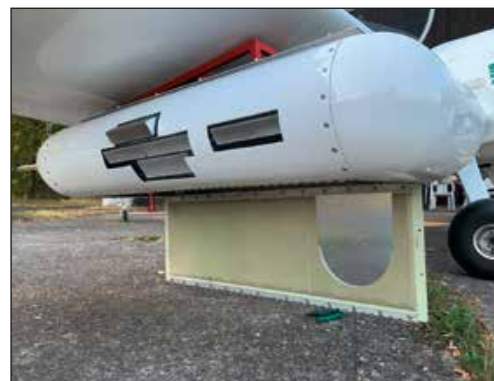
Abb. 1: MIRANDA35-4Rx System im Wingpod des Ultraleichtflugzeugs „Delphin“. Zu erkennen sind die vier Empfangsantennen (links) und die Sendeantenne (rechts) des Radar-Frontends
