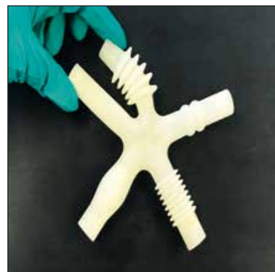
Abb. 1: Hohe Härte Silikongummi Bauteil, 3D gedruckt mit Material Jetting (Quelle: WIWeB)
