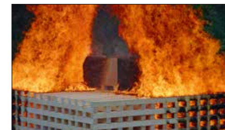
Abb. 5: Schutzschaumbildung auf Munitionskiste
