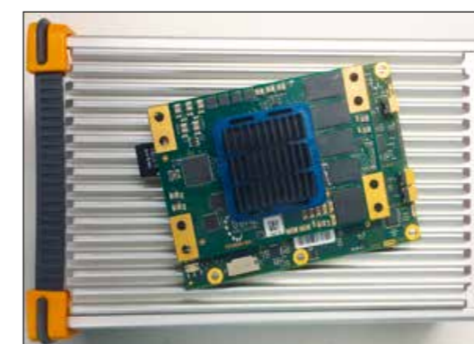
Abb. 2: Einbindung des PRS-Demonstrators als Hook-on-Device für sichere Positionsinformation im UAS-Verkehrssystem. Dies erfolgt als Gegenmaßnahme zu GPS-Täuschung (Spoofing)
