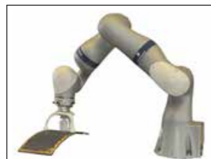
Abb. 2: Leichtbauroboter, der eine Ultraschallprüfung auf CFK durchführt
