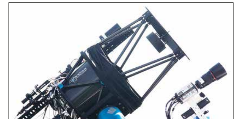
Abb. 5: Verwendete Staring Kamera (rechts) und 17 Zoll Nachführteleskop (links) mit montiertem Lasertransmitter
