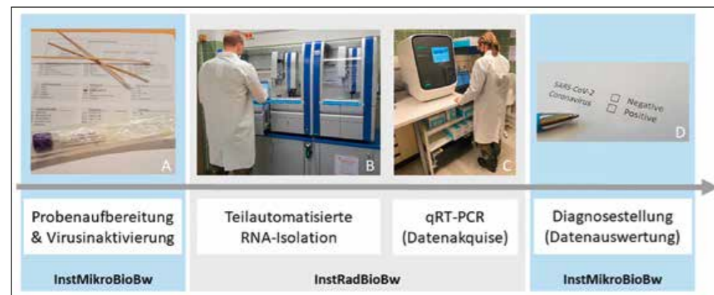
Abb. 1: Schematische Darstellung des institutsübergreifenden, teilautomatisierten Arbeitsablaufes A) Probenaufbereitung und Virusinaktivierung am InstMikroBioBw B) Teilautomatisierte RNA-Isolation mit dem QIAGEN QIASymphony® und C) qRT-PCR mit dem QuantStudio™ 12K OA Real-Time PCR System am InstRadBioBw D) Ergebnisinterpretation und Diagnosestellung am InstMikroBioBw
