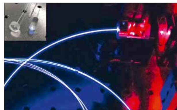
Abb. 1: Gepulster 2 \mu\text{m} -Faserlaser im Betrieb. Das kleine Bild zeigt verschiedene End-cap Designs
