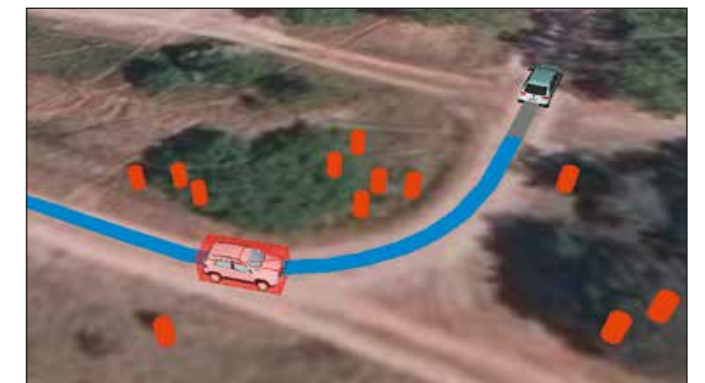
Abb. 4: Das Führungsfahrzeug überträgt kontinuierlich Landmarken (rot) und seine Trajektorie (blau)
