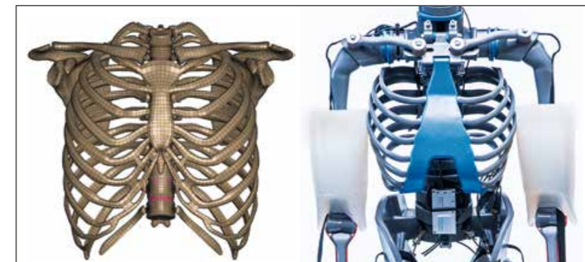
Abb. 4: Numerisches und experimentelles Abbild eines menschlichen Brustkorbs im Vergleich. Links: Computermodell (GHBMC M50, Quelle: Elemance). Rechts: Hardware (Biofidel-Dummy Primus, Quelle: Crashtest-Service.com GmbH)
