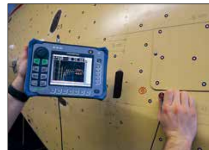
Abb. 1: Klassische Ultraschallprüfung an einer CFK-Hubschrauberstruktur
