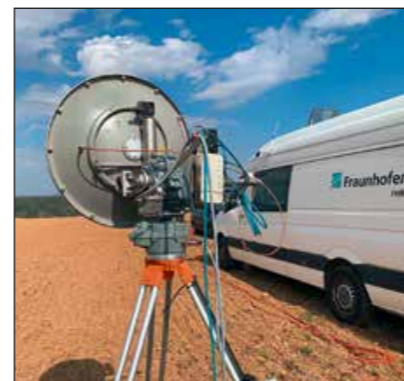
Abb. 3: Bodenstation (GCS) mit Telemetrie-antenne auf einem Feld südlich von Bad Breisig bei der 2020 Messkampagne mit dem Ultraleichtflugzeug „Delphin“
