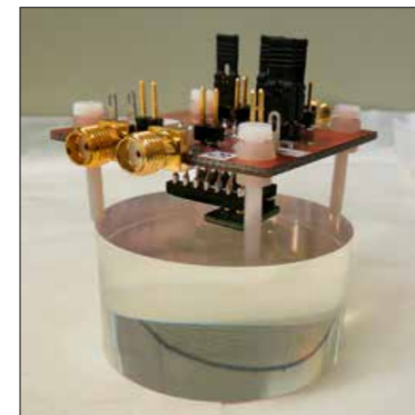
Abb. 3: Testaufbau der Silizium-Photomultiplier-Elektronik auf einem NE102A Szintillator
