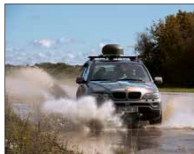
Abb. 2: SOTM Terminal mit Phased Array Antennentechnologie des Herstellers ADS (Quelle: ND SatCom, 2020)
