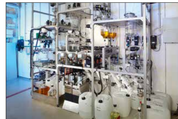
Abb. 3: Mikroreaktor-Anlage für die kontinuierliche Synthese und Produktaufbereitung von flüssigen Explosivstoffen im Kilogramm-Maßstab
