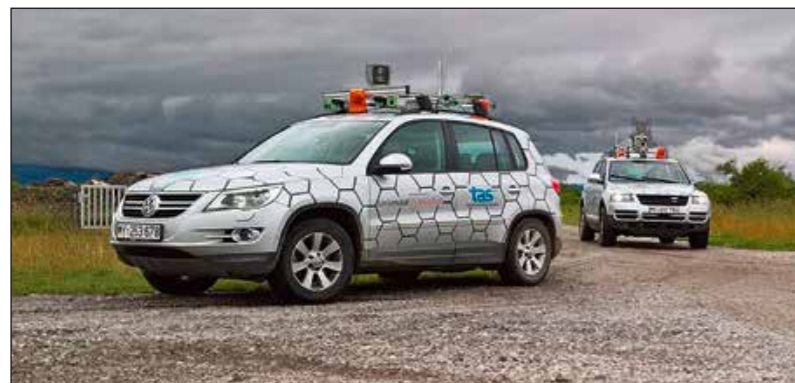
Abb. 1: Die Versuchsfahrzeuge MuCAR-3 und MuCAR-4 des Instituts für Technik Autonomer Systeme (TAS) mit auf dem Dach montierten LiDAR-Sensoren
