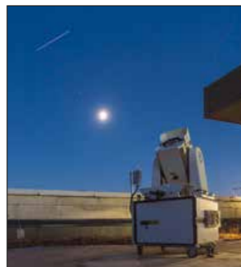
Abb. 2: Weitwinkel-Kamerasystem in gekapselter Einhausung bei Feldtests. Orbitale Objekte wie die internationale Raumstation im Bild werden als Strichspur detektiert
