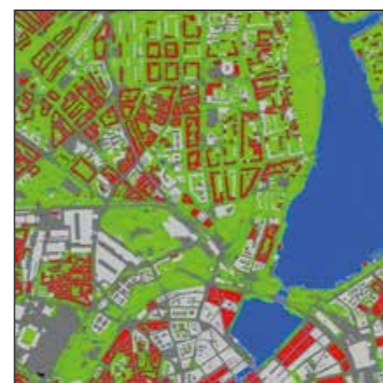
Abb. 2: Materialinformation abgeleitet aus einem Satellitenbild Hamburgs. Farbkodierte Materialkarte zu Abb. 1 (c): Rot: Ziegeldächer, Blau: Wasser, Hellgrün: Gras, Dunkelgrün: Bäume, Hellgrau: Beton, Dunkelgrau: Straße
