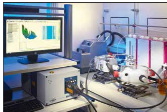
Abb. 2: Laboraufbau für das Reaktionsscreening mit spektroskopischer Prozessverfolgung mittels Lichtleitertechnik
