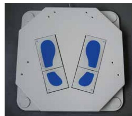
Abb. 3: Portables Posturographiegerät „Tetrax IBS“ der Firma Neurodata zur Erfassung der Gleichgewichtsregulation (Quelle: Dr. Carla Ledderhos, Bundeswehr)
