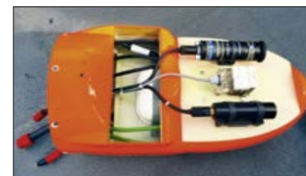
Abb. 3: Im Lastkopf der SeeKatze der Firma Atlas Elektronik verbautes Sensorsystem
