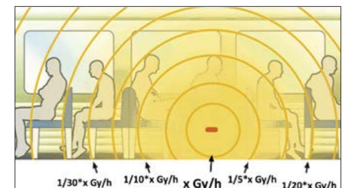
Abb. 3: Szenario einer, im Zug deponierten Strahlenquelle. Dosisleistung: Gy/h (Gray pro Stunde) (Modifiziert nach: https://www.remm.nlm.gov/red.htm (Stand 19. 12. 2016))
