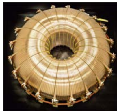
Abb. 2: Im Bau befindlicher toroidaler Induktivspeicher mit einem Energieinhalt von 1 MJ
