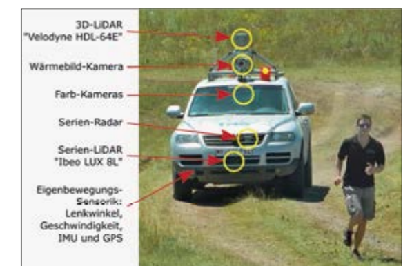
Abb. 4: Teach-In-Phase des Mule-Szenarios: MuCAR-3 folgt automatisch einer Person. Die in den Szenarien verwendeten Sensoren sind beschriftet
