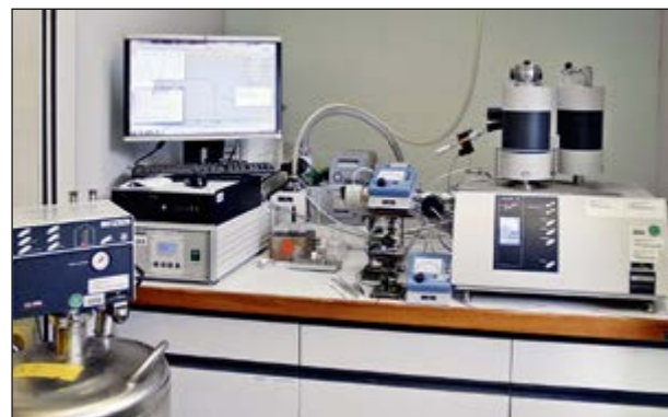
Abb. 1: Simultane Thermische Analyse (STA) Apparatur zur Durchführung von TG-DSC Messungen
