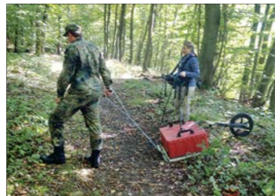
Abb. 3: Georadarmessung mit einer 200 MHz Antenne (roter Kasten) bei Breitenbenden, Eifel. Die unterirdische Römische Wasserleitung (jetzt trocken) wurde in diesem Waldgebiet gesucht und gefunden
