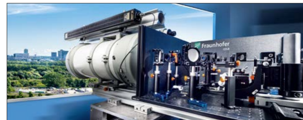
Abb. 3: Transportables Messsystem zur Charakterisierung und Korrektur atmosphärischer Turbulenz
