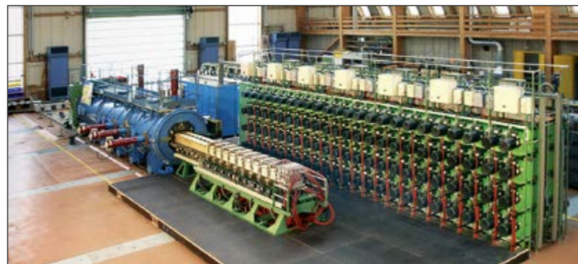
Abb. 1: ISL-Schienenkanone im Kaliber 40 mm mit einer Energieversorgung von 10 MJ
