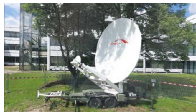
Abb. 2: 4,6 m Hub-Station im Einsatz während der Demonstration LTE over Satellite als Teil der Referenzanlage SatCERTBw
