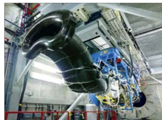
Abb. 2: Der MEIRD Forschungseinlauf, installiert am Larzac 04 Versuchsträger in der Triebwerkversuchsanlage des Instituts für Strahltriebwerke
