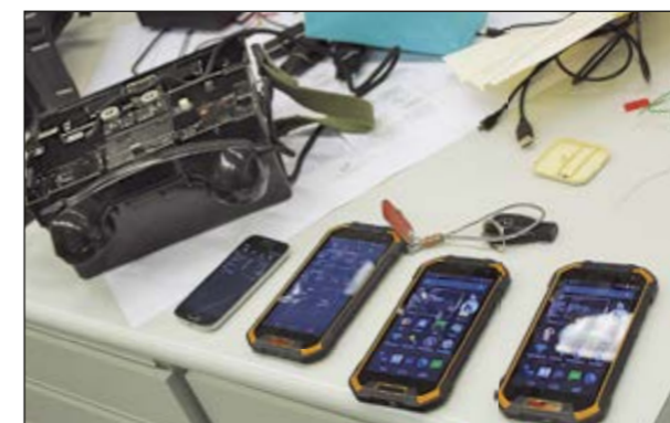
Abb. 3: Erfolgreiche Integration von Legacy Kommunikationsgeräten in den modernen Systemverbund LTE über Satellit. Zwischen dem Feldfernsprecher (FFOBZB) aus dem Jahre 1956 wurde erfolgreich eine VoIP Verbindung zu LTE User Equipment mit Android Betriebssystem aufgebaut
