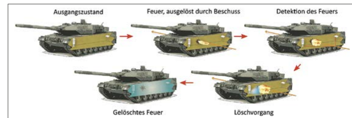
Abb. 3: Funktionsweise eines Brandunterdrückungssystems
