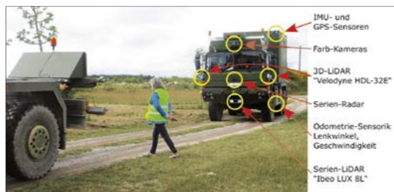
Abb. 2: TULF (Technologieträger unbemanntes Landfahrzeug) stoppt vor einem dynamischen Hindernis im Konvoi-Szenario. Die für das automatisierte Folgen genutzten Sensoren sind beschriftet
