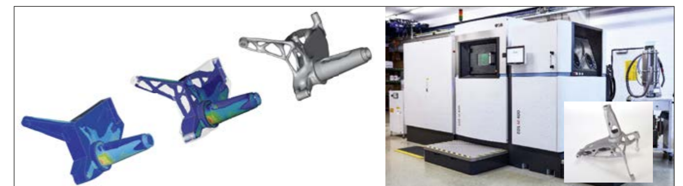
Abb. 2: Numerische Designoptimierung für einen Radträger und 3D-Druck des Zieldesigns mit der Lasersinteranlage am Fraunhofer EMI zur Bauteiluntersuchung und -erprobung
