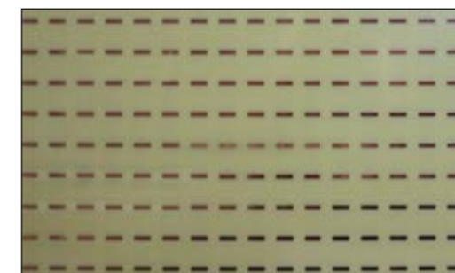
Abb. 4: Realisierung einer frequenz- und polarisationsselektiven Metaschicht als eine periodische Anordnung von Kupferstreifen auf dem FR4-Trägermaterial
