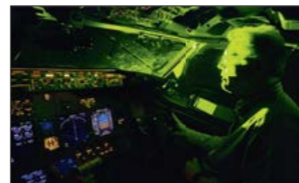
Abb. 3: Lichtüberflutung von Cockpit und Pilot durch einen 5 mW Laser mit Streuung an der Aussenverglasung des Luftfahrzeugs (FAA Public Release, 2008)
