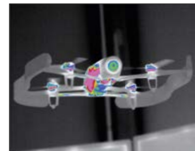
Abb. 3: Infrarotsignatur eines fliegenden UAV
