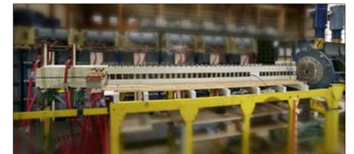
Abb. 4: Feuerstoßfähige Schienenkanone im Kaliber 25 mm
