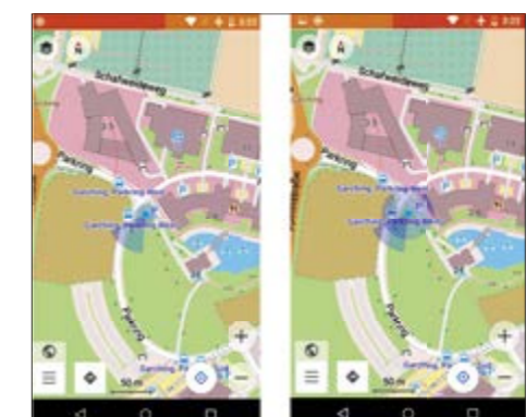
Abb. 5: Kartendarstellung der Eigenposition aus dem militärischen GNSS-Empfänger mit hoher und niedriger Genauigkeit (Größe des blauen Kreises) (Quelle: Fraunhofer AISEC)
