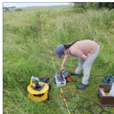
Abb. 2: Geoelektrikmessung im Messgebiet La Boisselle, Frankreich. In diesem Fall war die exakte Lokation der Minierstollen unbekannt
