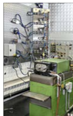
Abb. 2: FZG-Prüfstand mit Sensorfeld
