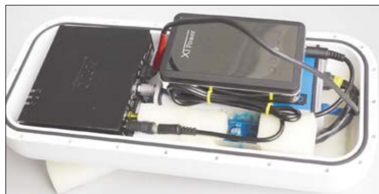
Abb. 2: Druckfestes Gehäuse mit Elektronik: Potentiostat, Mini-PC, Pumpentreiber, Stromversorgung
