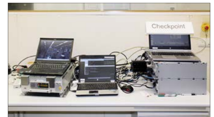
Abb. 4: Integration einer Sina Box in den Netzverbund im Rahmen der Demonstration an der UniBw München. Links: Sina Box mit VS GEHEIM Tunnel und Live-Videoübertragung über Satellit; Mitte: LTE Kernnetzwerk installiert auf einem handelsüblichen Laptop; Rechts: LTE Basisstation (eNodeB)
