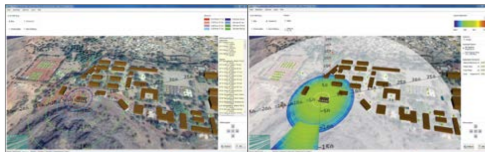
Abb. 2: Analysen mittels ESQRA-GE für unterschiedliche Lastfälle
