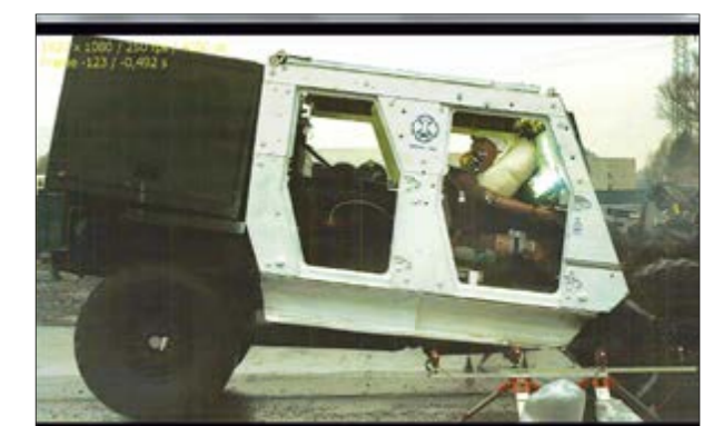
Abb. 4: Crashversuch mit GFF2-Fahrzeug
