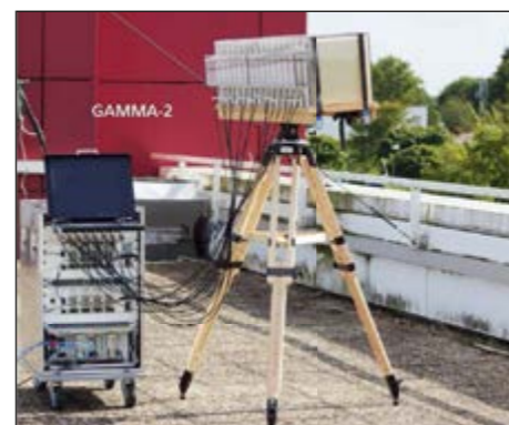
Abb. 2: Experimentelles 16-Kanal-Passivradarsystem, das Mobilfunkbasisstationen (GSM Broadcast-Signale) zur Drohnenbeleuchtung nutzt
