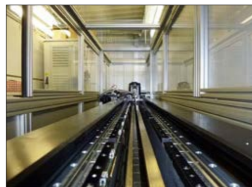
Abb. 2: Lineartisch in der Empfangsstation der Freistrahlestrecke
