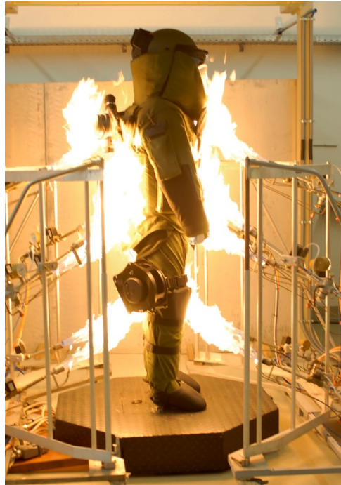
Beflammung eines Anzuges zur Entschärfung von Sprengstoffen beim Wehrwissenschaftlichen Institut für Schutztechnologien - ABC-Schutz (WIS), Munster
